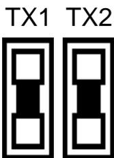
Wenn mehrere Endgeräte am  $S_0$ -Bus angeschlossen sind, ist es wichtig, daß die Kabel aller Geräte gleich gepolt sind. Falls ein verpoltes Endgerät am Bus hängt, oder eine Dose falsch beschaltet ist, können Sie die Polarität des ISDN-Master II umdrehen, indem Sie die beiden Steckbrücken TX1 und TX2 gemeinsam **um 90 Grad gedreht** einstecken.
