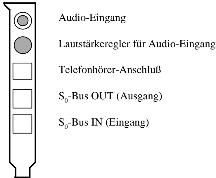
Die Anschlüsse des ISDN-Master II
