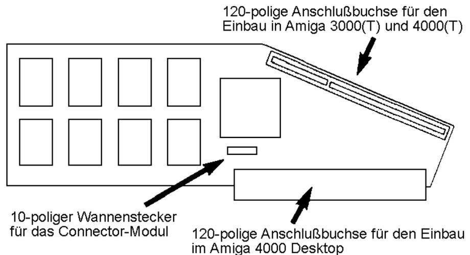
5. Identifizieren Sie den 120poligen Erweiterungsstecker auf der CYBERSTORM MKIII/PPC-Beschleunigerkarte. Dieser befindet sich auf der rechten oberen Seite wie in Abbildung 3 dargestellt.
