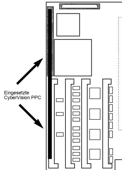
Backplane berührt, wenn z.B. der Rechner im eingeschalteten Zustand versehentlich einen Stoß abbekommt. Im Amiga 3000 und Amiga 4000 Tower wird die CyberVision PPC, aufgrund der abweichenden mechanischen Abmessungen in diesen Geräten, wie in Abbildung 5 bzw. Abbildung 6 gezeigt, auf die CYBERSTORM MKIII/PPC-Beschleunigerkarte installiert. In diesen Rechner-Modellen entfällt der Einsatz der Isolator-Pappe.
