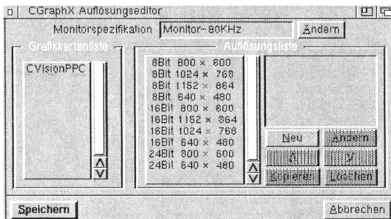
Dieses Programm dient zur Erstellung eigener Monitordefinitionsdateien. Es unterteilt sich in zwei Bereiche. Der erste Bereich definiert die Grenzwerte des Monitors und der zweite Bereich dient zur Konfiguration der Auflösungen. Das Fenster zur Definition der
