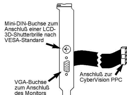
7. Da die CyberVisionPPC im Amiga 4000 Desktop nahe an der Backplane (Zorro-Slot-Platine) sitzt, stecken Sie bitte die mitgelieferte Isolator-Pappe zwischen die Cyber-Vision PPC und die Backplane. Wenn die Pappe entlang der Markierungen gefaltet wird, kann sie auf die Trägerschiene über der Backplane gelegt und ggf. mit einem Klebestreifen fixiert werden. Diese Isolation vermeidet, daß die CyberVision PPC die
